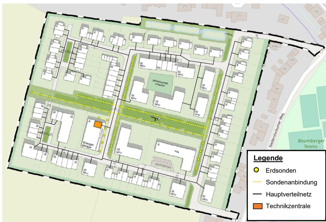
Abbildung 18: Sonden- und Verteilnetzsystem bei der Umsetzung eines Nahwärmenetzes
