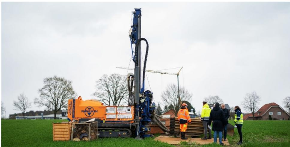
Abbildung 13: Geothermal Response Test im Rahmen eines Projektes im Kreis Wesel
