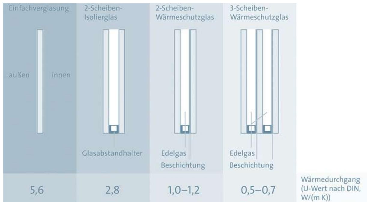
Abbildung 3-1: Wärmedurchgang bei Ein- bis Dreifachverglasung
