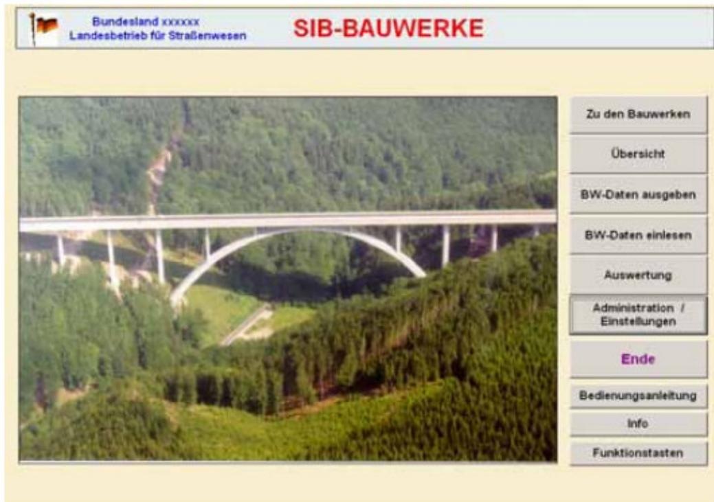
Die aufgenommenen Schäden werden mit Ziffern zwischen 1-4 getrennt für die drei Aspekte Standsicherheit, Verkehrssicherheit und Dauerhaftigkeit eingestuft. Zur Vereinheitlichung und Vergleichbarkeit der Schadensfeststellung liegt ein umfangreicher Beispielskatalog für typische Schäden und deren Bewertung vor.
