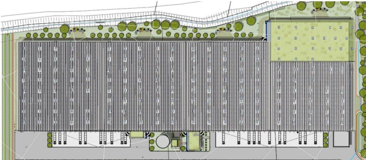
Abbildung 9: Darstellung der Photovoltaikbelegung Szenario 2
