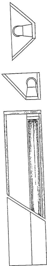
Rück- bzw. Vorderansicht und Querschnitt eines liegenden und Querschnitt eines stehenden Lichtkastens
