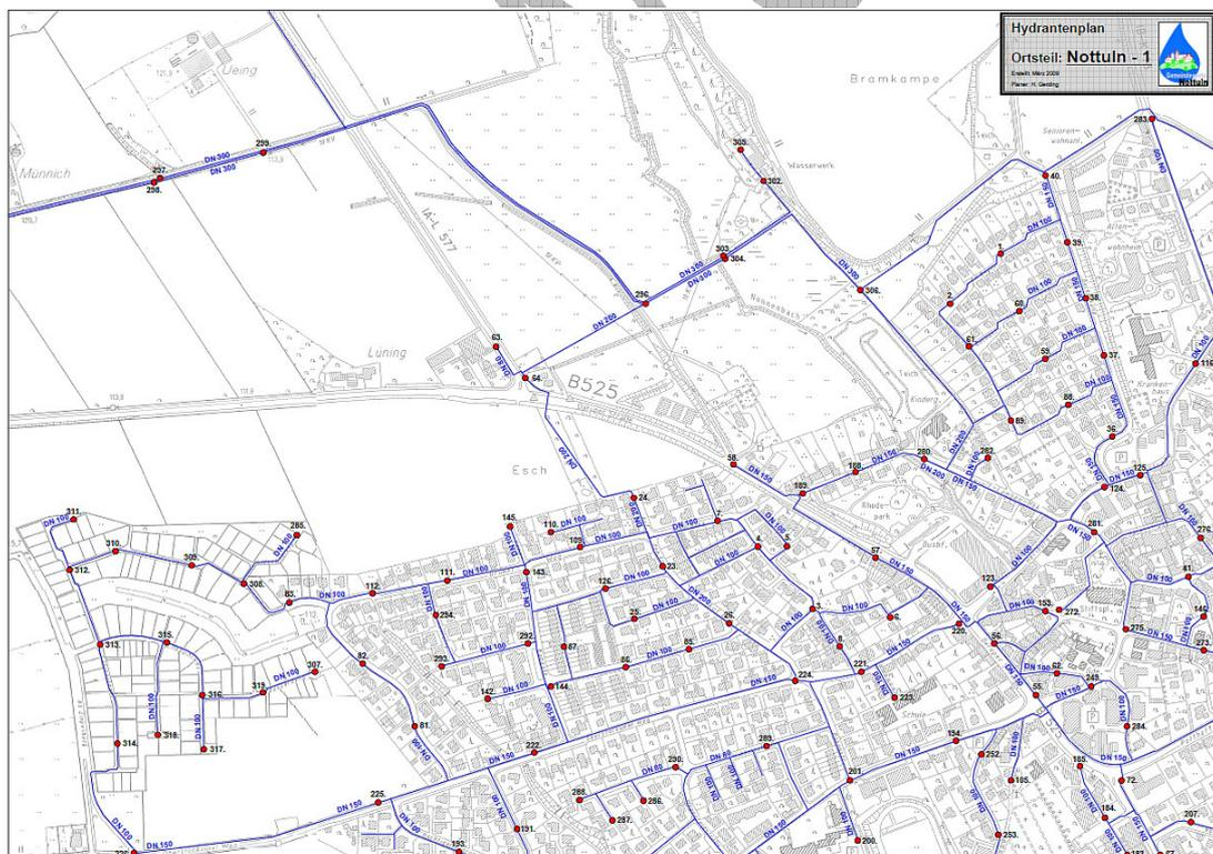
Abb. 9a: Trinkwasserversorgungsnetz mit Hydranten, Detailplan Nottuln Nordwest
