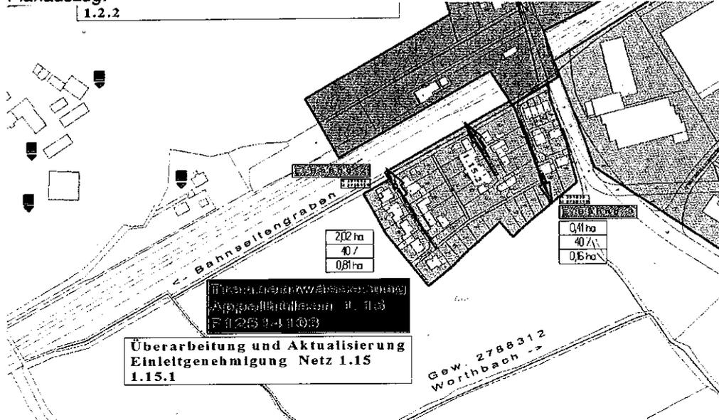
In die Stever entwässern 2 Netze ungedrosselt aus dem Ortsnetz, sowie die Einleitungen des Lippeverbandes aus dem RÜB und der ARA Nottuln-Appelhülsen mit der amtlichen Bauwerksnummer 7357 des RÜB.
