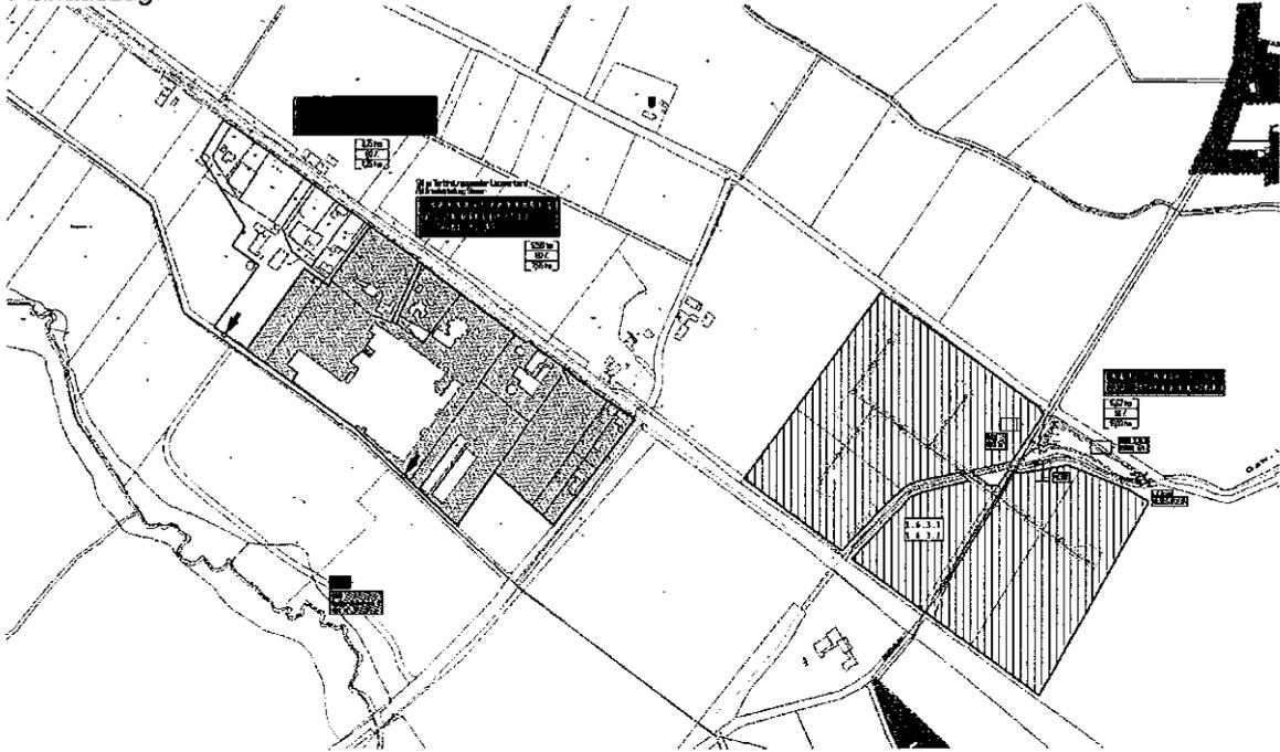
Aktuell ist eine Erweiterung des Gewerbegebietes in der Umsetzung. Das Netz 1.6.3 "GE Beisenbusch" ist bereits wasserrechtlich genehmigt und der Baubeginn ist erfolgt. Das Netz entwässert im Trennsystem. Der NW-Anteil entwässert über ein RKB und RRB an ein namenloses Nebengewässer zur Stever. Der SW-Anteil wird über ein Pumpwerk dem Verbindungssammler zur Kläranlage Nottuln-Appelhülsen zugeführt. Das Netz weist eine Größe von 16,67 ha  $A_{E0}$  bzw. 16,00 ha  $A_{EU}$  auf.
