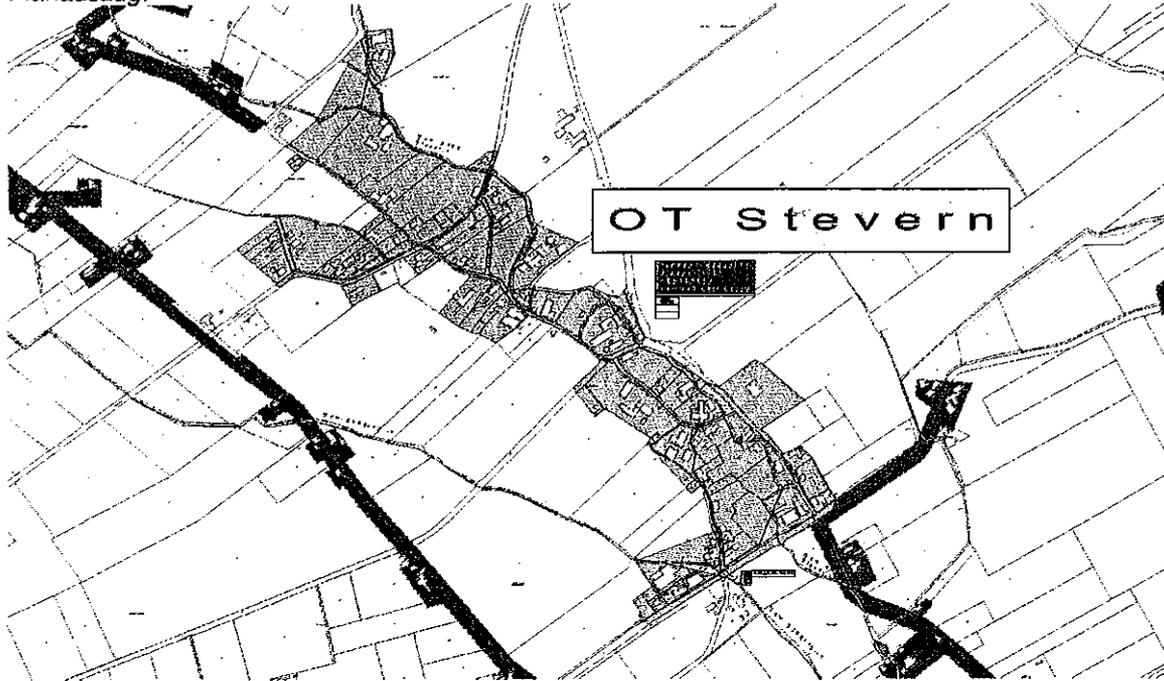
Der Ortsteil Stevern entwässert im Trennsystem. Der NW-Anteil wird dem Nebengewässer 278812 oder direkt der Stever zugeführt. Die Entwässerung erfolgt als Anliegerentwässerung weitgehend privat direkt zum Gewässer. Der öffentliche Schmutzwasseranteil wird über ein Pumpwerk mit Druckleitung dem Mischnetz Nottuln zugeführt. Die Netzgröße wird in Summe der Einleitungen mit ca. 40,9 ha A<sub>E0</sub> angegeben.
