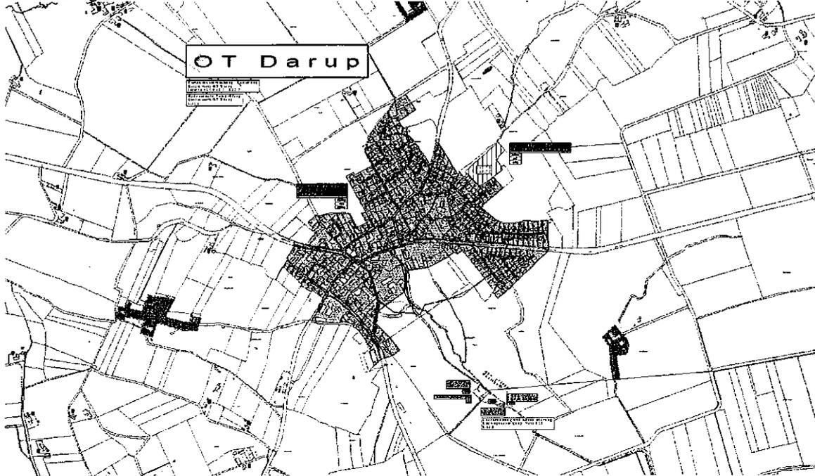
Der NW-Anteil wird gedrosselt nach Teilbehandlung in einem RKB über ein RRB dem Hagenbach zugeführt. Die Netzgröße beträgt nach dem MW-Nachweis von 2008 ca. 55,5 ha  $A_{E0}$  bzw. 25,0 ha  $A_{EU}$ . Die Bauwerke mit den amtlichen Nummern 7318 für das RKB und 7759 für das RRB mit einem Volumen von ca. 2310 m<sup>3</sup> sind vorhanden.
