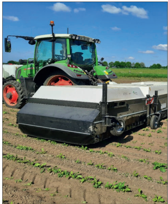
Abb. 2: Spot-Spraying ARA im Zuckerrübenversuchsfeld
