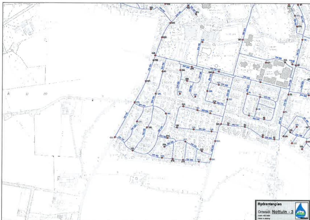
Abb. 9c: Trinkwasserversorgungsnetz mit Hydranten, Detailplan Nottuln Südwest
