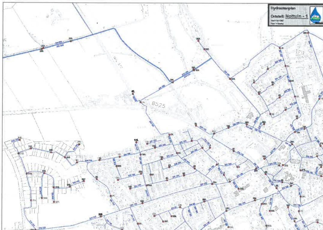
Abb. 9a: Trinkwasserversorgungsnetz mit Hydranten, Detailplan Nottuln Nordwest
