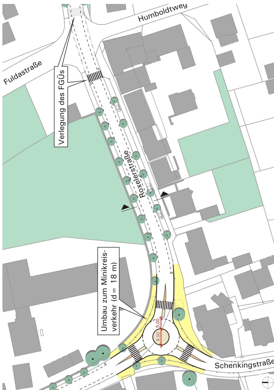
Abb. 73 Umgestaltungsvariante 2: Umbau des Knotenpunktes Roxeler Straße/Schenkingstraße zum Minikreisverkehr, Schutzstreifen
